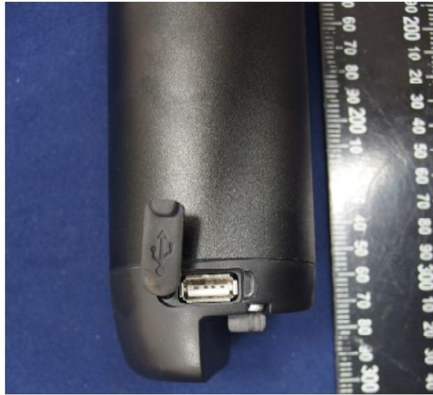
圖 5 抽取式二次鋰電池組之 USB 輸出端
