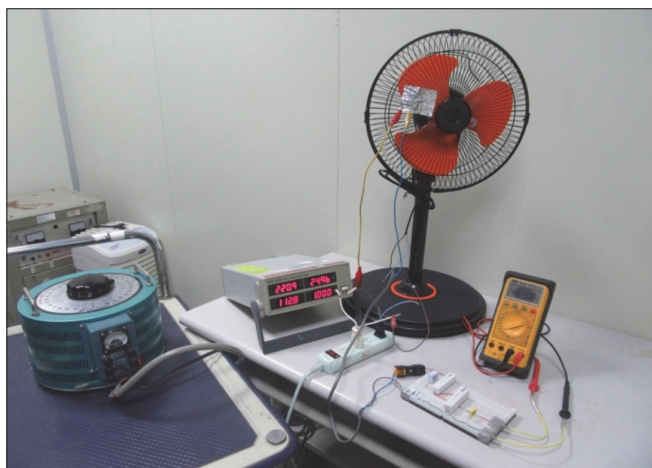
(a) 扇網直接通L相或N相電壓（葉門電壓220 V），人體接觸電流測試情形
