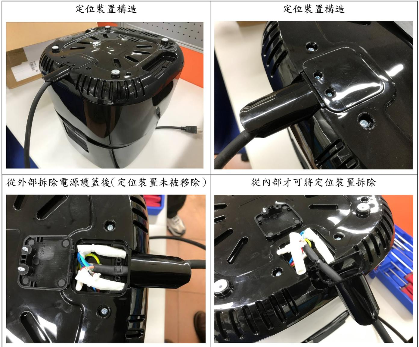
此構造無法直接從電器外部以手、螺絲起子或扳手移除防止電器貼牆過熱之定位裝置，請討論是否可符合 CNS 60335-1 第 22.17 節要求？
