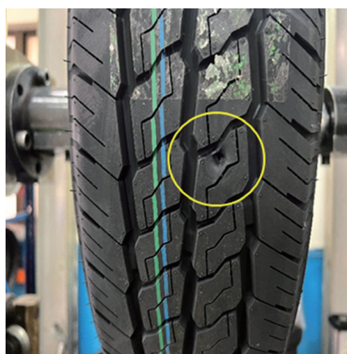
圖 3 輪胎強度試驗不合格案例
