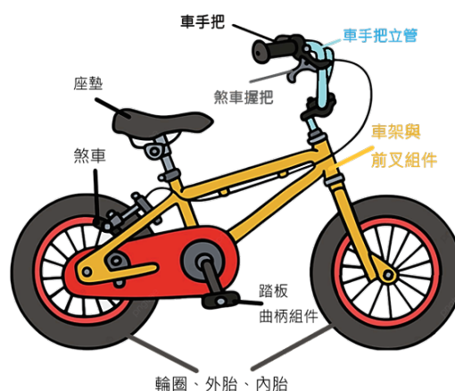
圖 1 兒童自行車組成結構
