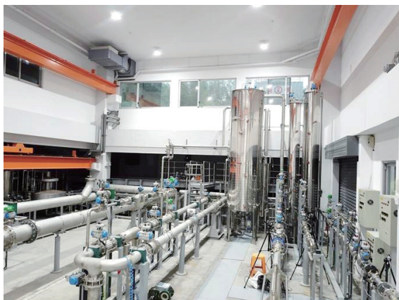
圖3 水量計型式認證檢測系統
