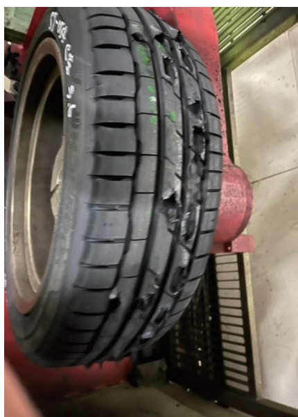
圖 1 高速性能試驗不合格案例
