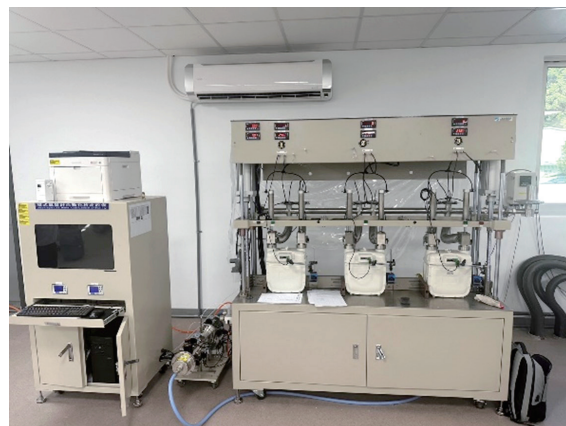
圖4 膜式氣量計型式認證檢測系統
