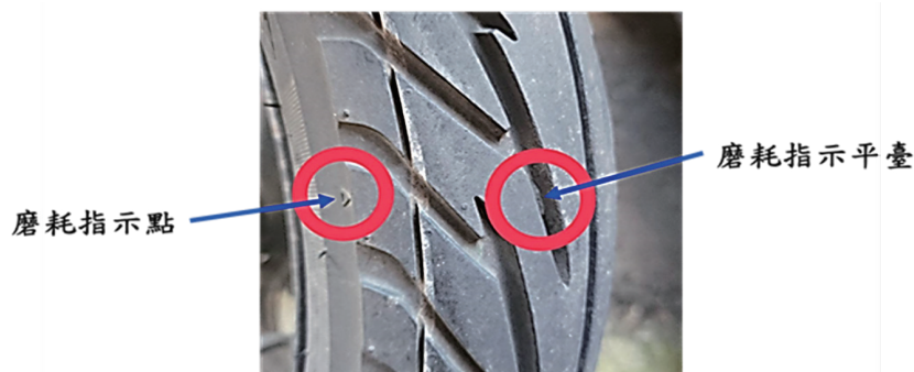
圖 5 輪胎磨耗指示點及磨耗指示平臺
