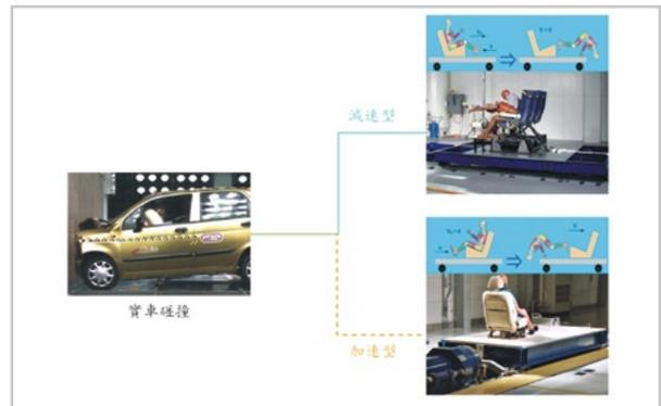
▲ 圖1. 模擬碰撞系統之分類
